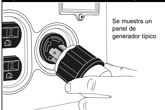
Figura 36 — Alineación de los conectores en el generador
